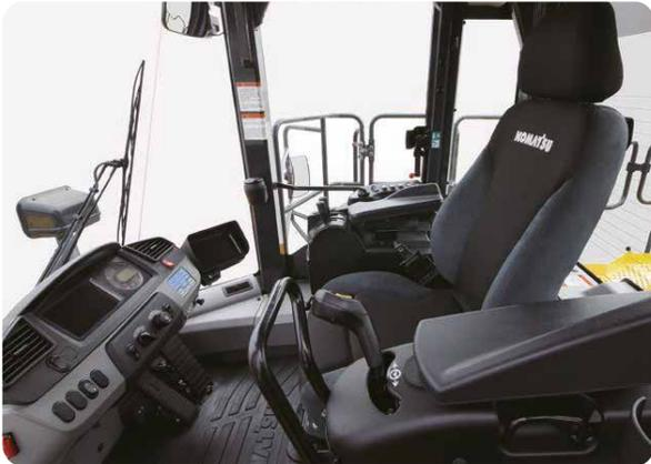
Amplia y confortable cabina que incluye sistema de protección certificada ROPS / FOPS.
