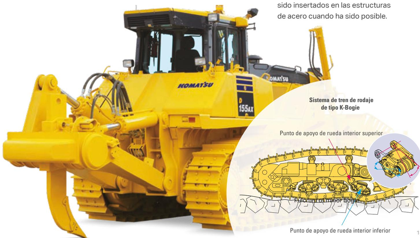
Sistema de tren de rodaje de tipo K-Bogie
