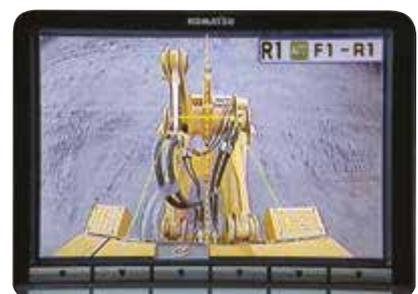
Sistema integrado de cámara para visibilidad trasera.
