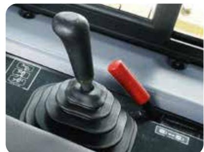
Palancas remotas de bloqueo de seguridad.
